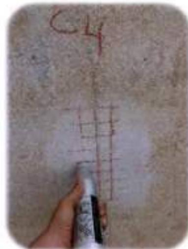
Photo 30 : Essai sclérométrique
